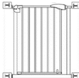
**Шаг 2.** С помощью ручек отрегулируйте положение опор таким образом, чтобы резиновые прокладки плотно прилегали к стенам со всех сторон. Чем сильнее затянуты ручки, тем надежнее будут зафиксированы ворота.
